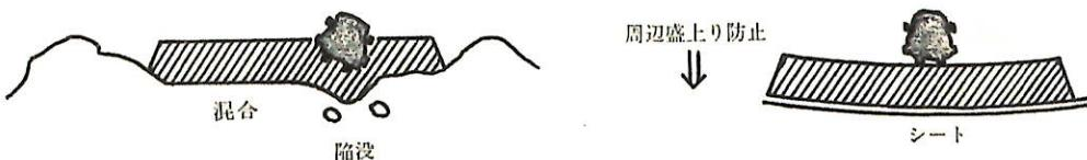
図 5-20 直接まき出し工法とファゴットシート工法
