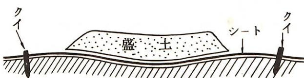
図-24 道路造成時のシート引張力増加方法
